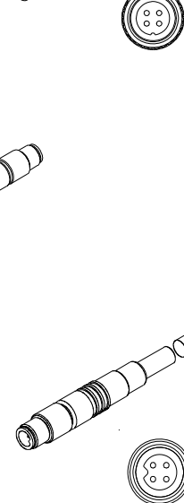
cab-4/USB-... oder cab-4/USB-w-... (ohne Abb.) (Länge je max. 5m, Mantel: PU)
