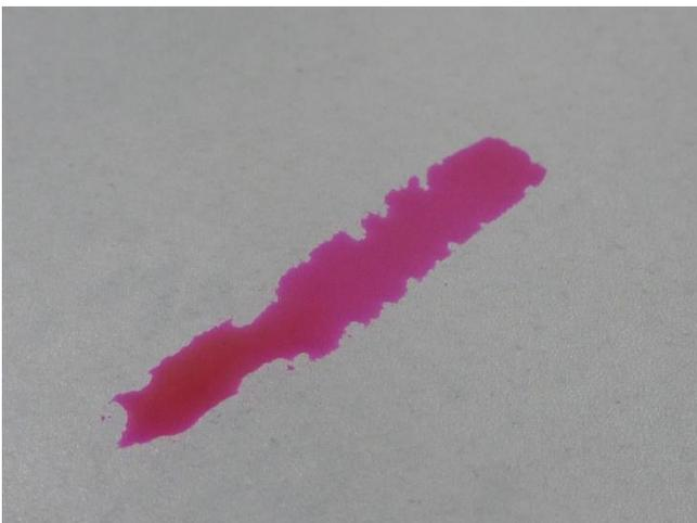
Dans cette illustration, l'encre de test adhère à la surface métallique mouillée d'huile ou bien dégraissée. La tension superficielle de la surface métallique est par conséquent supérieure à la valeur de l'encre de test indiquée.
