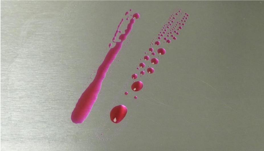
Des encres de test sont par exemple proposées par la société arcotest GmbH [www.arcotest.info](http://www.arcotest.info). Les encres de test PINK couvrent ici une plage une plage de tensions superficielles comprise entre 22 mN/m et 60 mN/m en pas de 2 mN/m.
