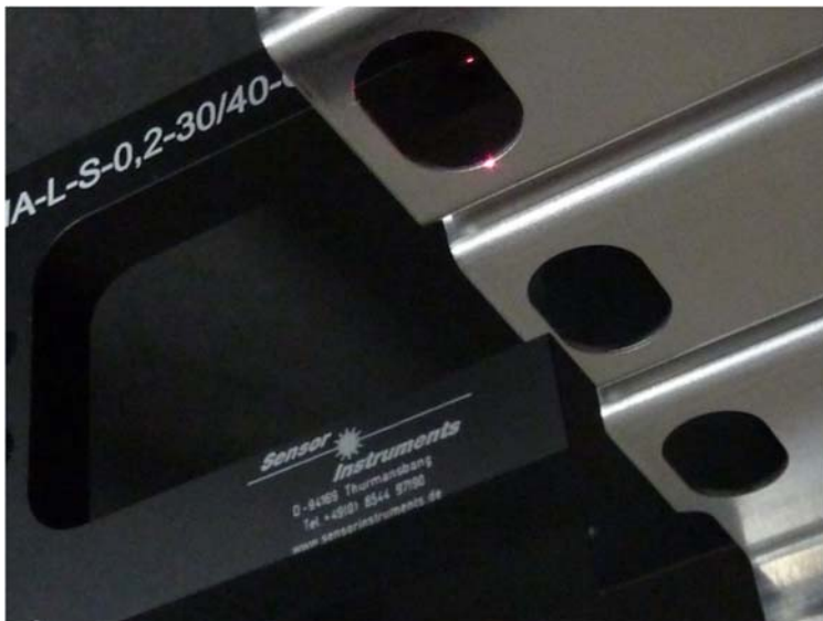
Präzise Positionierung des Stanzteils mittels FIA-L-RL Gabellichtschranke
