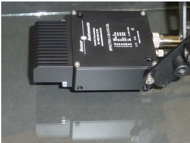
Sensorik SPECTRO-1-20-UVC-DIL, gerichtet auf die Zinnseite eines Floatglases
