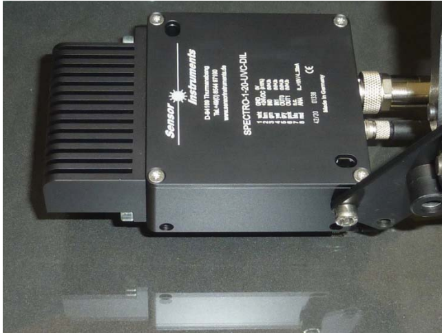
Sensorik SPECTRO-1-20-UVC-DIL, gerichtet auf die Feuerseite eines Floatglases aus einem Abstand von 20mm
